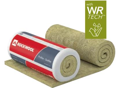
ProRox WM 960<sup>ES</sup> es una manta de aislamiento de lana de roca ligeramente adherida, cosida con alambre de acero galvanizado a una malla de acero galvanizado. Puede solicitarse con malla y alambre de acero inoxidable (SW). Las mantas armadas se fabrican con un innovador aglomerante hidrófobo denominado WR-Tech™ que mitiga el riesgo de corrosión bajo aislamiento (CUI).
